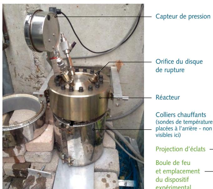
Photo du dispositif expérimental
