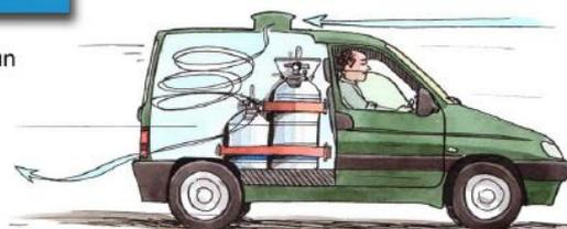
Si vous transportez l'azote liquide dans un véhicule classique, limitez la quantité (**25 litres maxi**) et ventilez en ouvrant les vitres.
